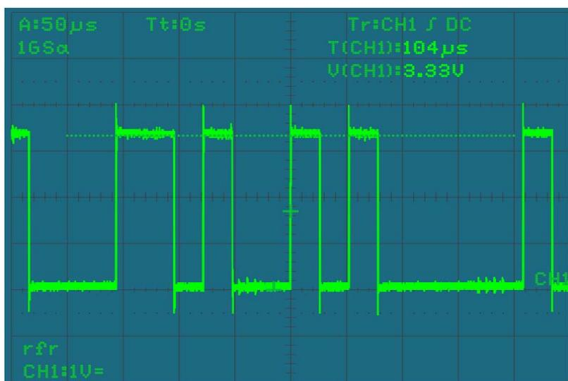
TTL Signalpegel, der zum Betrieb des NL-550ERS nötig ist.
