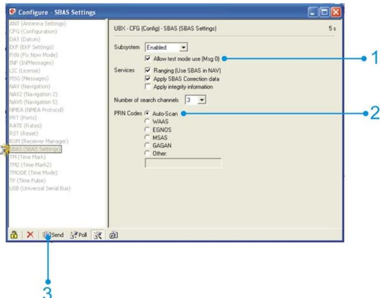
EGNOS befindet sich noch immer im Testbetrieb. Der schon lange geplante Übergang zum Regelbetrieb wurde immer wieder verschoben. Daher ist der Einsatz der EGNOS Korrektur in den Engine Modulen im Werkssetup deaktiviert. Es ist nicht gesagt, dass durch den Einsatz dieser Korrekturwerte, die Positionsbestimmung derzeit besser wird. Es muss jeder Nutzer für sich selber entscheiden, ob er es nutzen möchte.
